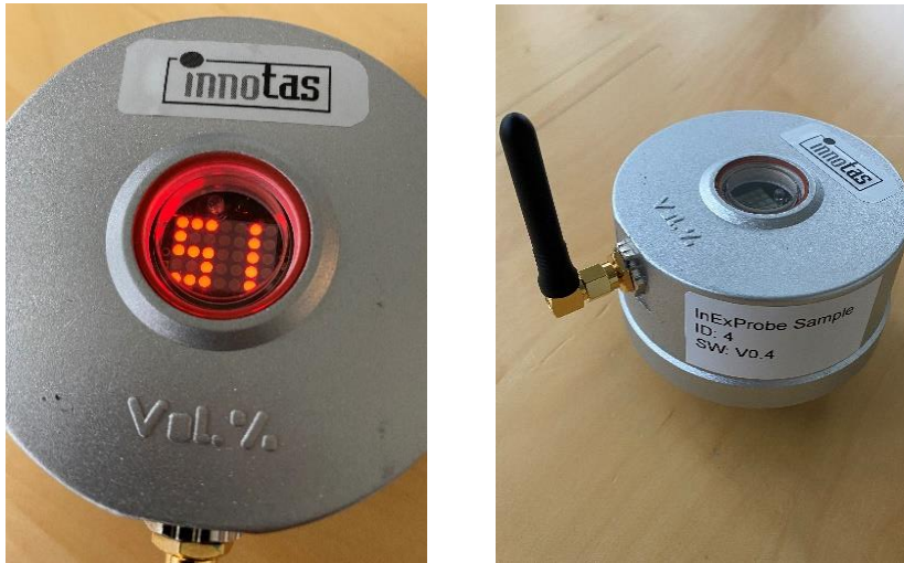
Abb.1: Prototyp, Vorserienmuster der IoT-Sonde für die ATEX-Zertifizierung
