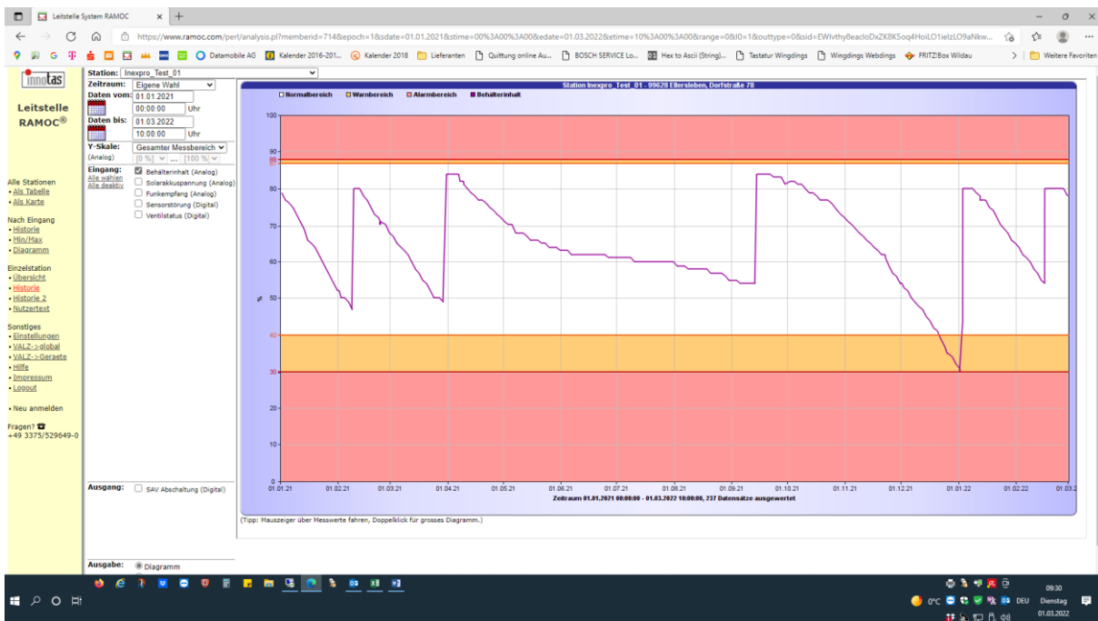
Abb.2: Screenshot einer Füllstandshistorie vom Erprobungsstandort einer InExProbe- Sonde. Dargestellt auf einer virtuellen Leitstelle auf der RAMOC-Internetplattform. Warnbereiche werden rot dargestellt, Vorwarnbereiche gelb.
